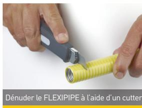
Dénuder le FLEXIPIPE à l'aide d'un cutter
